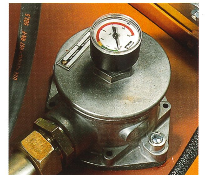
Hydrauliköl- und Filterüberwachung durch Manometer
